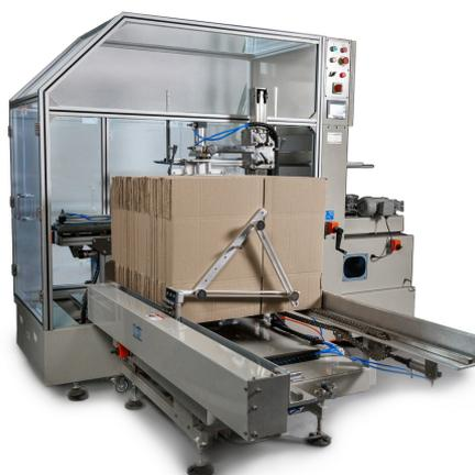
Автоматические сборщики коробов серии СХJ-С предназначены для автоматической программируемой сборки коробки из вырубки, вертикального формования, складывания нижних ушей и заклейки низа коробки.
