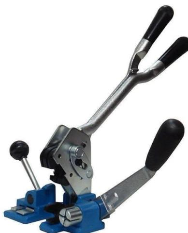
Комбинированное устройство представляет собой объединённое на одной базе совмещение двух ручных механических инструментов: натяжителя и клещей.
