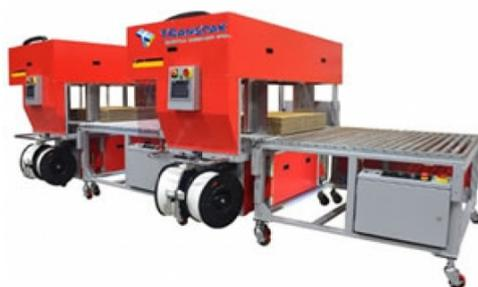
TP-702CQ3-T – автоматическая машина для стреппинг обвязки гофрокартона. Подходит для встройки в упаковочную конвейерную линию. Оборудование останавливает идущую по линии пачку картона, выравнивает ее с помощью специальных фиксаторов (спереди и с боков) и обвязывает стреппинг лентой, после чего стопка листов продолжает свой путь по конвейеру. Это одна из самых скоростных машин в своем классе: 32 одинарные или 26 двойных обвязок за минуту!
