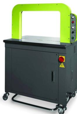
Автоматическая стреппинг машина Extend EXS 125 (Тайвань) позволяет обвязывать упаковки ПП лентой со скоростью 40 обвязок в минуту без потерь силы натяжения. EXS-125 может успешно применяться для обвязки книг, картонных коробов, печатных СМИ и во всех других областях, где главную роль играют скорость и качество. Конструкцией машины предусмотрено расположение бухты с лентой внутри корпуса, что делает данную модель более компактной и безопасной по сравнению с машинами данного класса.
