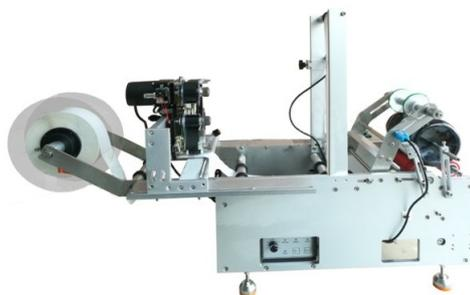
УМ130 – аппликатор этикеток - полуавтоматический - на круглую продукцию. С помощью этого аппликатора этикеток можно нанести этикетку на бутылки, банки, валики и многое другое.
