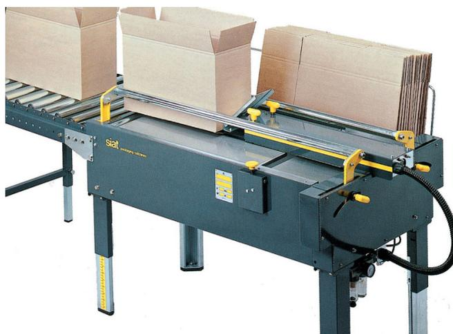
Модель F-104 представляет собой полуавтоматическую машину для закрытия нижних створок картонного короба, оснащенную пневматическим толкателем. Производство компании Siat, Италия. Формовщик коробов F-104 легко объединяется с заклеивщиком коробов, освобождая оператора от утомительных операций и экономя его время.
