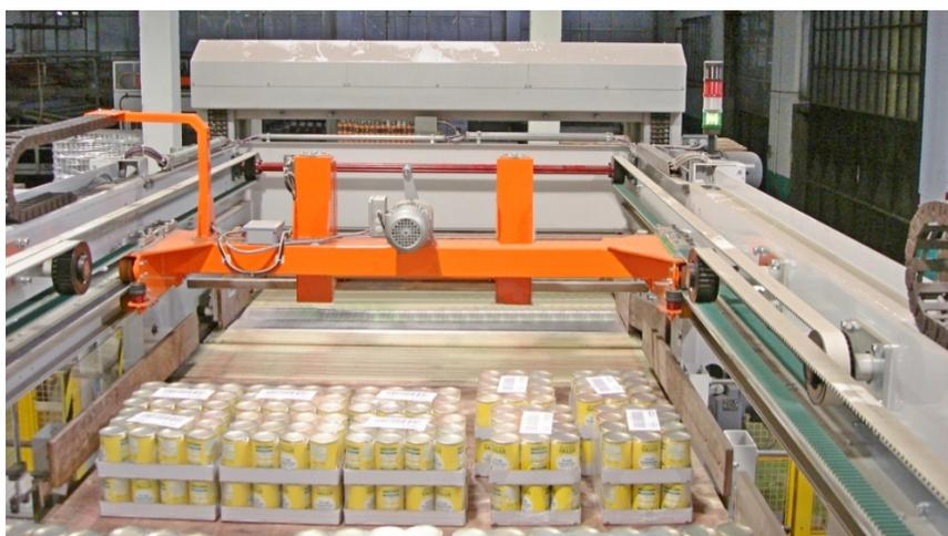
Паллетайзер с верхней подачей продукции для укладки коробов, термоусадочных блоков на паллет. Корпус машины состоит из двух колонн. Паллет перемещается сверху вниз, по мере укладки на него слоев.
