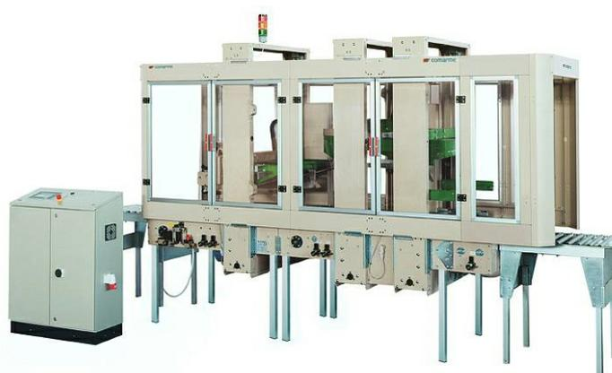
Автоматический заклещик коробов клейкой лентой. Предназначенный для встраивания в автоматические линии, где коробка разных размеров одновременно поступают с нескольких станций упаковки.
