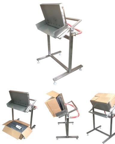
Установка стерилизации туб ИПКС-124Т(Н) разработана для групповой стерилизации жестяных и пластиковых туб в транспортной таре из гофрокартона, имеющих высоту от 230 до 250 мм, длину от 580 до 600 мм и ширину от 380 до 400 мм. Это оборудование предназначено для использования на предприятиях пищевой, косметической и фармацевтической промышленности.
