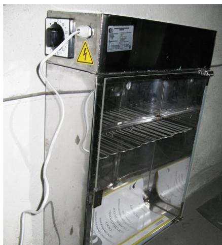
Ультрафиолетовый стерилизатор СНУ-1 предназначен для обеззараживания ножей больших и малых размеров и других инструментов на предприятиях пищевых отраслей промышленности, торговли и общественного питания.
