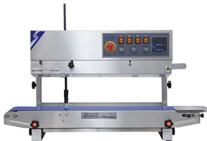
Конвейерный роликовый запайщик FRBM-810II представляет собой модель вертикального типа, которая используется для запайки пакетов в вертикальном положении (стоя). Вертикальная подача не позволяет содержимому пакета высыпаться (или вылиться), можно подстроить аппарат под различную высоту пакетов в пределах возможного диапазона регулировки.
