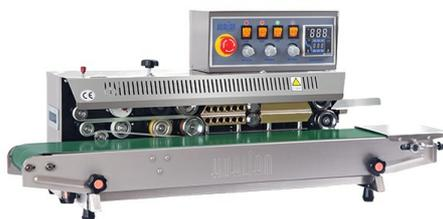
FR-980I – настольная модель серии роликовых конвейерных запайщиков, предназначенная для запайки пакетов в горизонтальном положении (плашмя). Для запайки пакетов с жидкими и сыпучими продуктами рекомендуется модель с вертикальной запайкой FR-980II.
