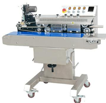
Роликовый конвейерный запайщик FRMC-1120W с функцией откачки воздуха предназначен для запайки пакетов средней тяжести. Максимальный вес одного пакета – 2,5 кг, общая допустимая нагрузка на конвейер – 7,5 кг. Запайщик устанавливается на консоли с подвижными колесами. Корпус выполнен из окрашенного порошковой краской металла. Наличие функции откачки воздуха позволяет уменьшить объем пакета и увеличить срок хранения продуктов.
