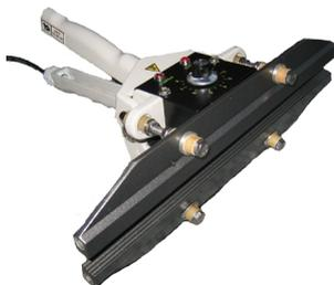
FKR 300 – еще одна модель из серии ручных запайщиков постоянного нагрева в виде клещей. Длина запаечной планки в данной модели – 300 мм, мощность нагрева 500 Вт. Две запаечные губки (верхняя и нижняя) формируют прочный шов шириной 10 мм.
