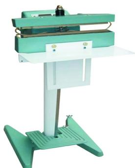
PFS-300DD – еще одна модель серии промышленных ножных запайщиков с постоянным нагревом. Длина запайки в данной модели составляет 300 мм. Привод ножного типа упрощает работу с тяжелыми, габаритными пакетами, а регулируемый нагрев запаечных планок обеспечивает выбор оптимального режима запайки в зависимости от толщины и плотности материала. Не предназначен для использования на пакетах из ПВД и ПНД.
