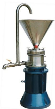
JML130 является наиболее производительной моделью в серии промышленных коллоидных мельниц вертикального типа JML. Ее производительность составляет 1-4 т/час.
